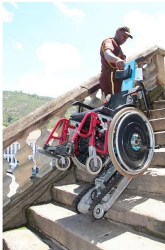
Figura 22 - Mecanismo de transporte inclinado de uma cadeira de rodas
